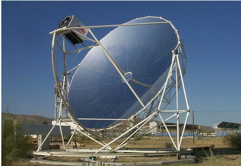
Plataforma Solar de Almería (Espagne), moteur Stirling installé au foyer d'un miroir parabolique.
